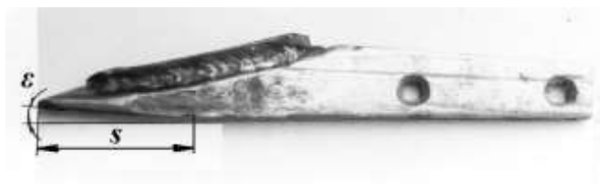
Рисунок-8. Лыжевидная форма носка долота образованная после 8 га при верхней дифференцированной наплавке.
