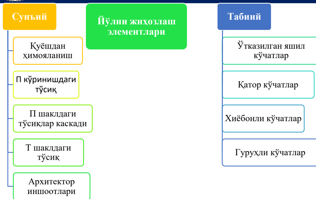
6 – расм. Йўлларни ҳимоявий жихозлаш элементлари турлари
