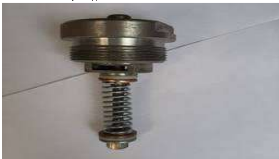
5-расм. Совутиш тизимининг буғ-ҳаво клапани
